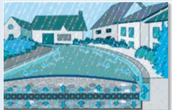
Revêtement imperméable : injection par un drain.
