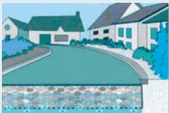
Vidange par infiltration dans le sol support.
