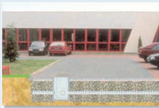
Chaussée réservoir. La collecte est assurée par un regard à grille.
